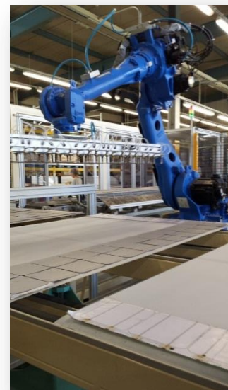
(Macchinario che dispone le celle di silicio sul pannello di vetro alla SunAge SA.)
